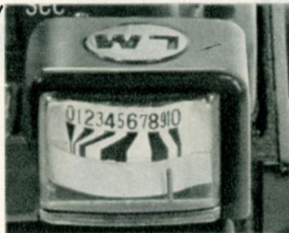
(上) LMの電気露出計部分
